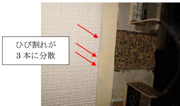
写真1 ひび割れ分散性の確認実験
